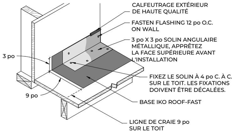
DÉTAIL DE RACCORDEMENT RÂTEAU/MUR
