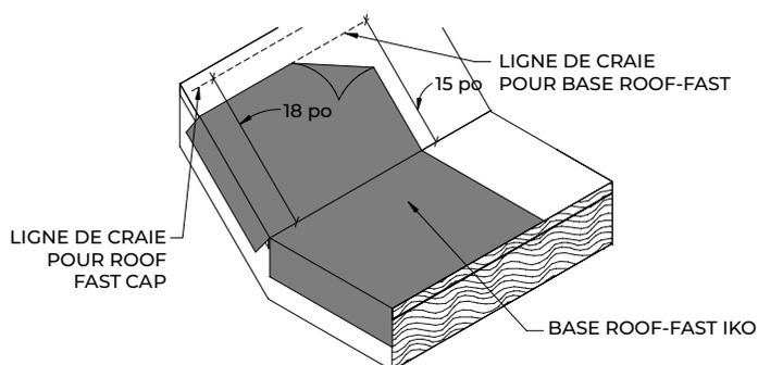
DÉTAIL DE RACCORDEMENT POUR PENTE RAIDE
