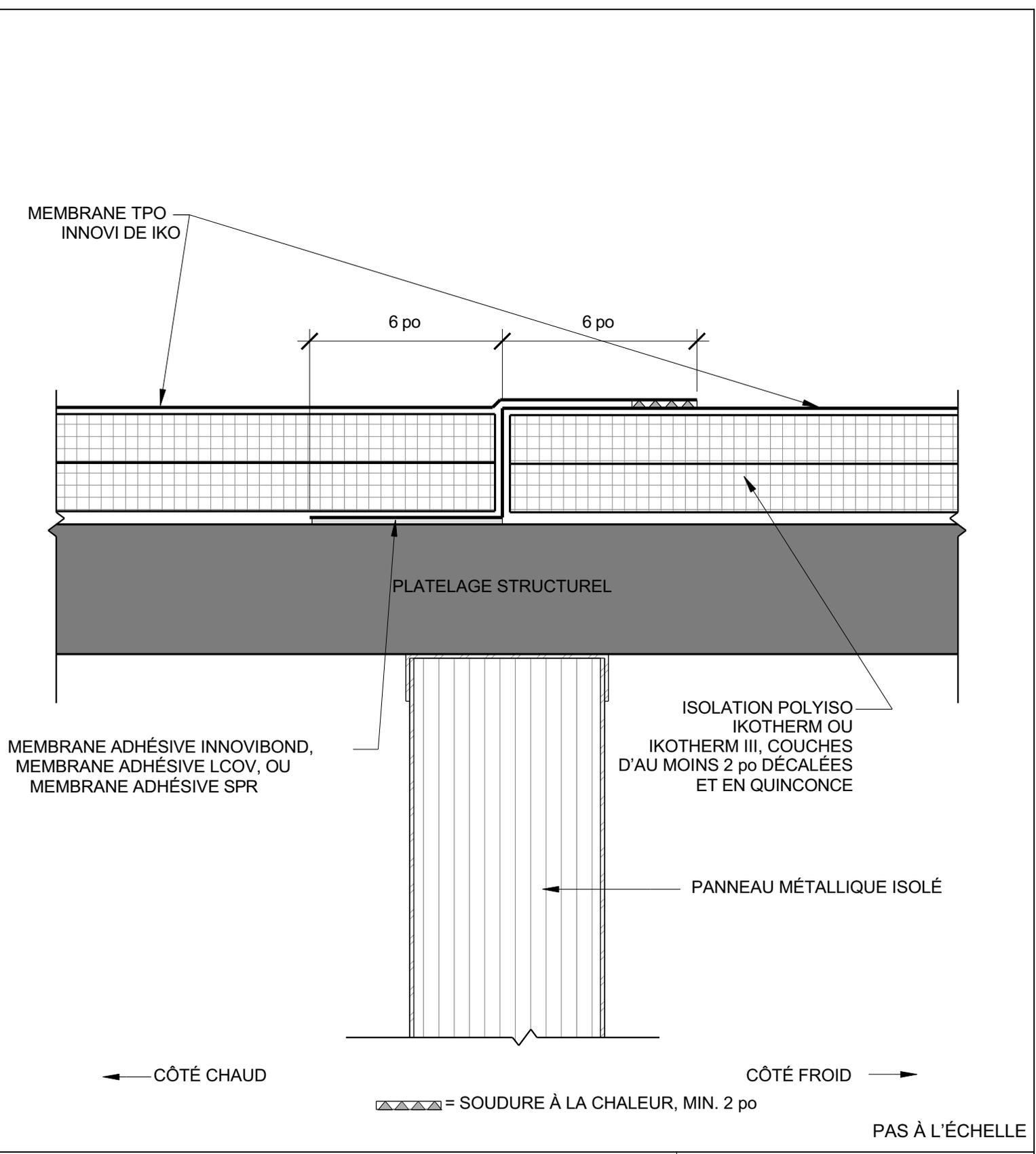
Titre : TRANSITION – TABLIER MÉTALLIQUE ISOLÉ SOUS LE PLATELAGE
